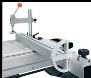
Guía de precisión de corte angular milimetrada Guide de précision de coupe en onglet millimétré Angular millimeter precision guide cut
